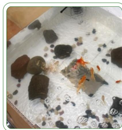
En 2007, une boîte d'emballage en carton a été peinte avec 100% d'étanchéité revêtement Sun Glare SX à utiliser comme un pool de poissons. Il peut également être fabriqué avec Sun Glare, Sun Glare 20 ou Sun Glare 30. Toutes les fenêtres acryliques sont collées avec du Elastic Cement
